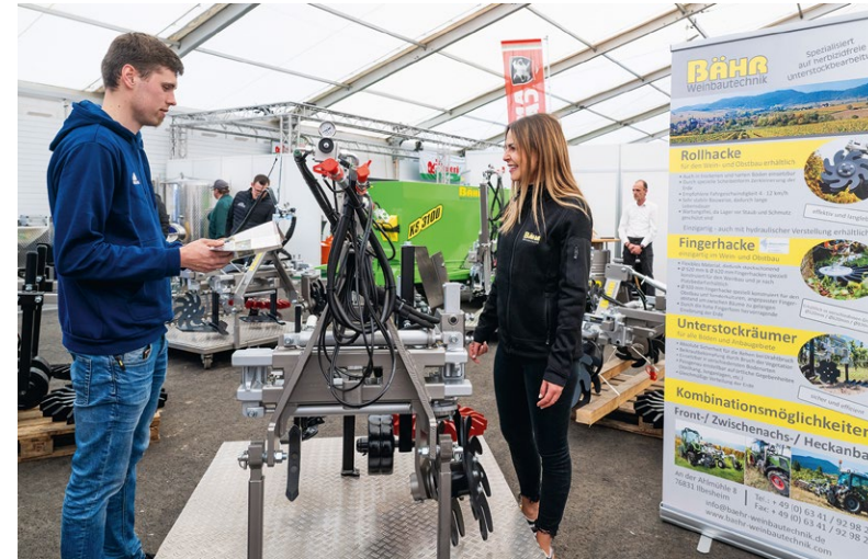
Praxisnahe Technik war bei Bähr Weinbautechnik zu sehen, etwa die Rollhacke und auch die Fingerhacke für den Unterstockbereich.
